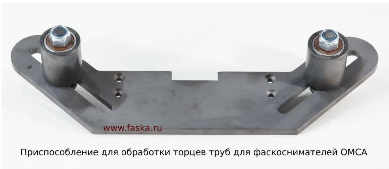
Приспособление ОМСА 790 представляет собой роликовую направляющую для базирования по стенке трубы которая может выполнять роль горизонтальной или вертикальной направляющей в зависимости от способа установки на фаскосниматель. Способ установки трубного приспособления ОМСА 790 в свою очередь определяется удобным или приемлемым положением трубы в процессе снятия фаски.
