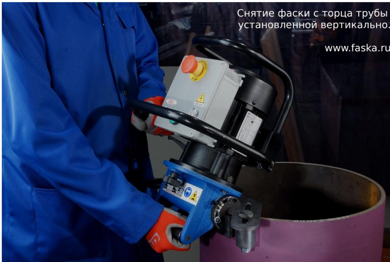
Настройка фаскоснимателя для такого способа обработки выполняется так: трубное приспособление устанавливается вместо горизонтальной направляющей с роликами. Фаскосниматель с правильно установленным трубным приспособлением должен выглядеть так:
