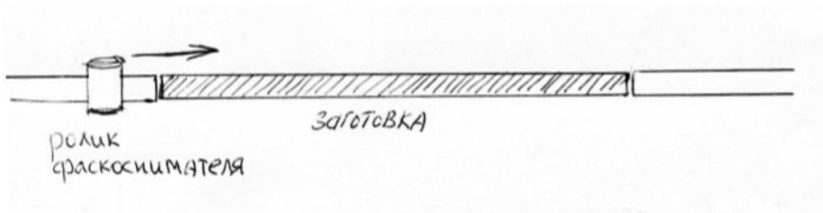
Можно обойтись и без дополнительных приспособлений но обработку в таком случае надо начинать не от самого начала, а отступив немного чтобы обеспечить ролику контакт с торцом, и плавно подвести работающий станок к кромке так же как и в случае, например, обработки отверстия.
