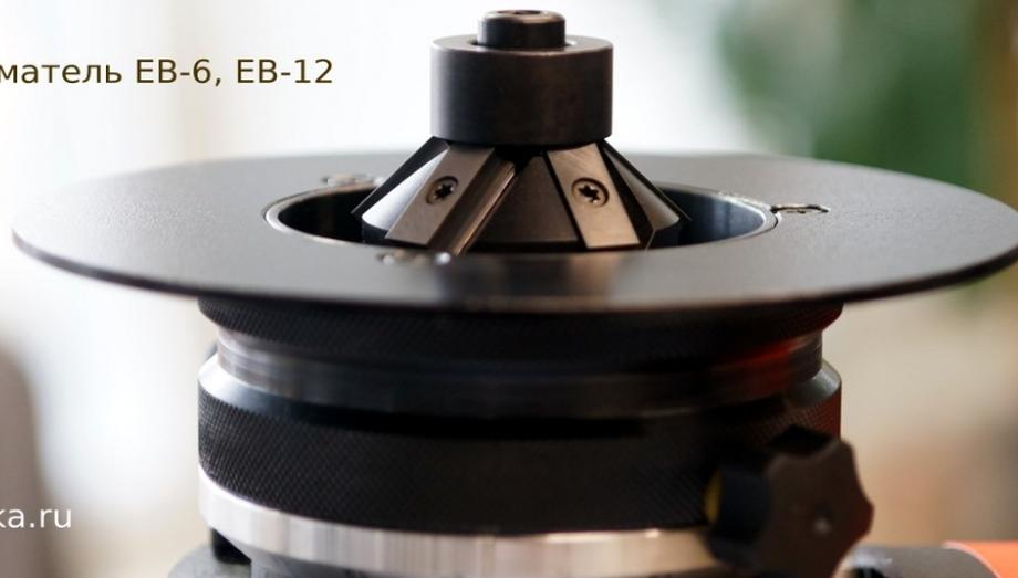
Такая конструктивная особенность фаскоснимателей EB-6 и EB-12 требует учитывать то что для корректной работы необходим постоянный контакт вертикальной роликовой направляющей с торцом заготовки как в начале обработки, так и в конце. Идеальным случаем для таких фаскоснимателей является область с “непрерывным торцом”. Например, отверстие которое образует непрерывный торец или другая произвольная “внутренняя” область. В таких случаях можно без риска поломки использовать фаскосниматели EB-6 , 12.
