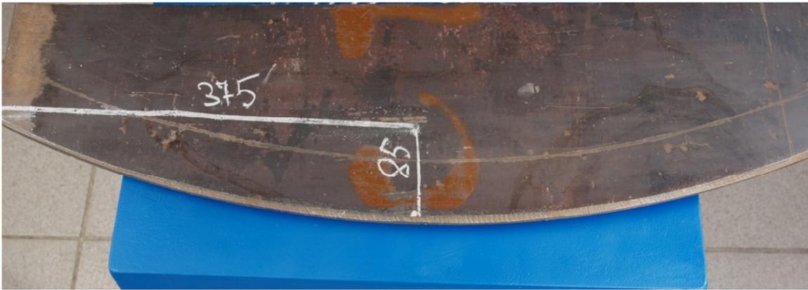
Рисунок 1 ФАСКА НА РАДИУСНОЙ КРОМКЕ ПОЛУЧЕННАЯ ФАСКОСНИМАТЕЛЕМ СНР-12
