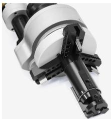
1. Резедержатель позволяющий установить 3 резца одновременно. Процесс автоматической сварки предусматривает безупречное качество подготовки торца что достижимо при выполнении наружной фаски, торцевания и расточки внутреннего диаметра за одну установку.
